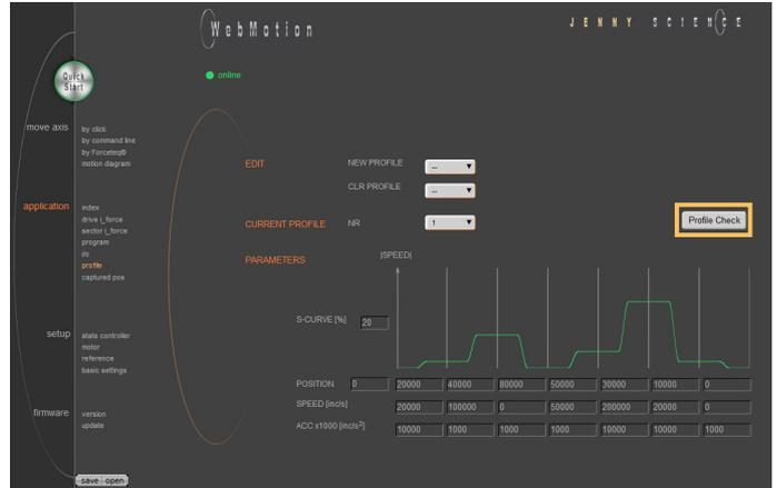
Beim Start eines Profils ist sicherzustellen, dass sich der Motor an der vordefinierten Startposition befindet.
